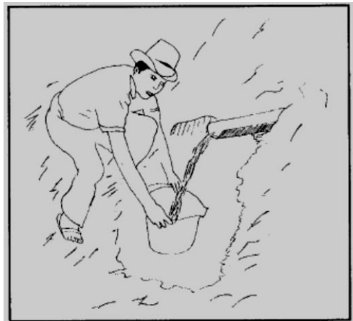
Figura N° 12: Aforo de Agua
