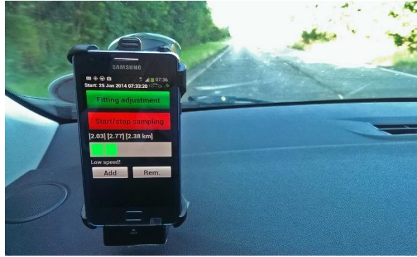
Figura 38: Medición del IRI con la aplicación Roadroid
