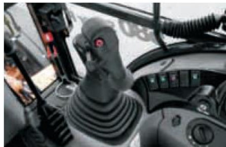
Figura N° 19 Sistema hidráulico y controlador de cargador
