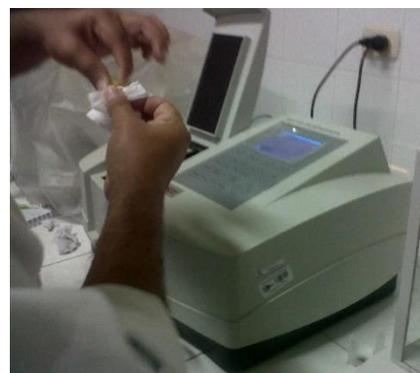
Leer la absorbancia a 540 nm en espectrofotómetro uv visible
