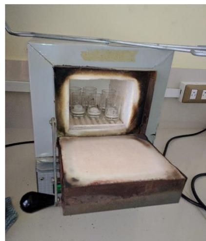
Determinar cenizas del residuo obtenido (m2) mediante incineración en mufla a 500 °C
