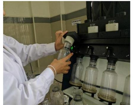
Colocar los matracos y crisoles en el equipo de filtración
