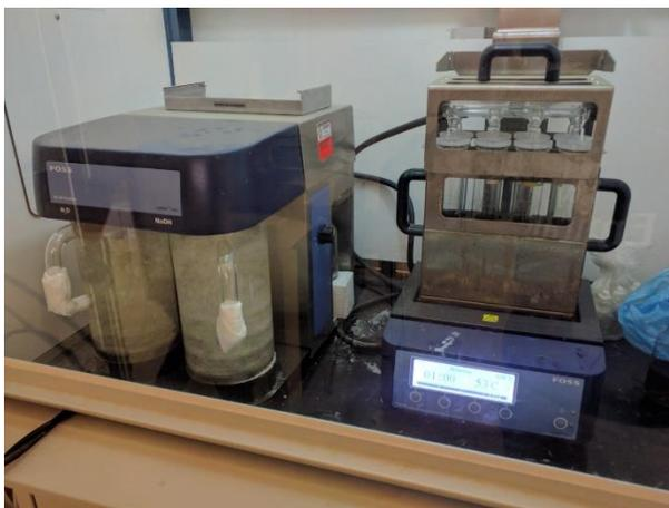
Determinar proteínas del residuo obtenido mediante equipo Kjeldal (m1)
