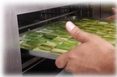
**Figura 19:** Secado de residuos de esparrago por Secador de Bandejas.
