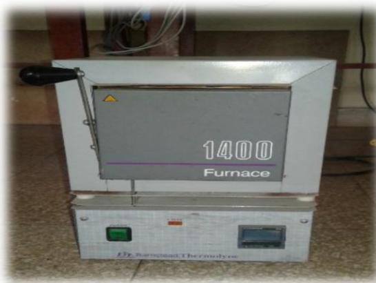
$$\%Cenizas = \frac{\text{Peso final}_{\text{muestra+crisol}} - \text{Peso inicial}_{\text{crisol}}}{\text{Peso de la muestra}}$$
