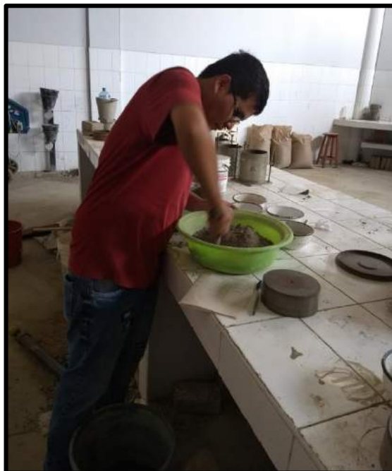
FOTO 12. Mezclado de las muestras con el óptimo contenido de humedad.
