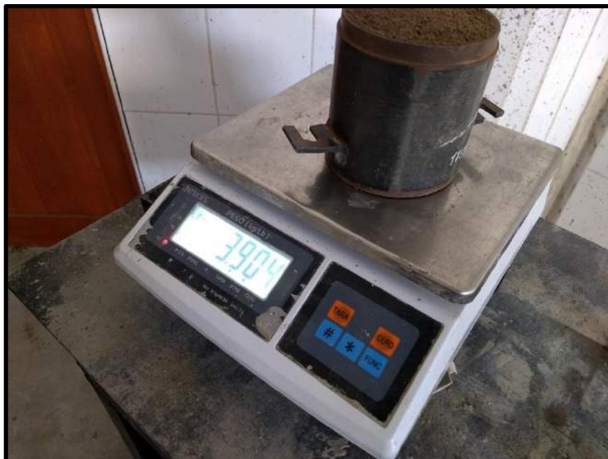
FOTO 10. Peso de la muestra compactada y enrasada.
