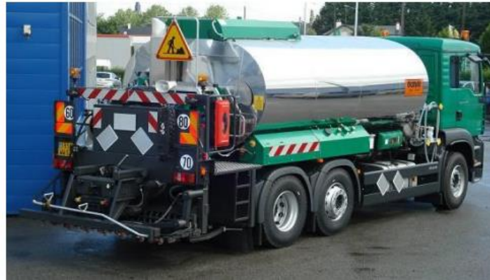
Figura N°05: Cisterna de Riego de Ligante
