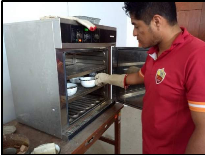
FOTO 07. Obtención de los contenidos de humedad para realizar el correcto cálculo de los límites de atterberg.
