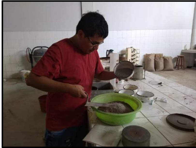
FOTO 17. Mezclado de la muestra con cemento y el óptimo contenido de humedad calculado.
