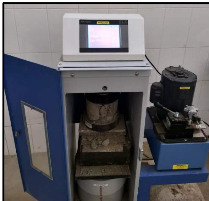
FOTO 20. Ensayo de resistencia a la compresión de las probetas suelo - cemento.
