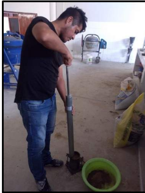
FOTO 09. Compactación en capas de las muestras en los moldes.
