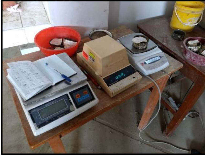
FOTO 11. Peso de las muestras secas para obtener el contenido de humedad utilizado en el ensayo de Proctor Modificado.
