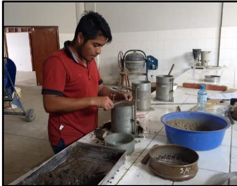
FOTO 13. Enrasado del molde para luego colocar los anillos espaciadores.
