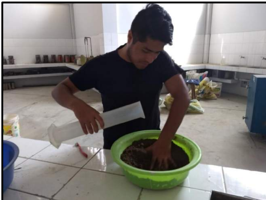
FOTO 08. Mescla de la muestra extraída con diferentes cantidades de agua y cemento.
