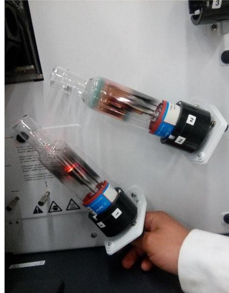
Lámparas de cátodo hueco para Cu y Fe (posición 1 y 2 respectivamente).
