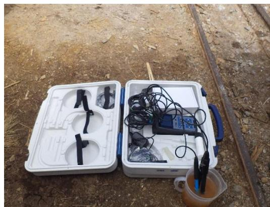
Análisis *in situ* de parámetros: pH, temperatura y Conductividad. Utilizando un multiparámetro.
