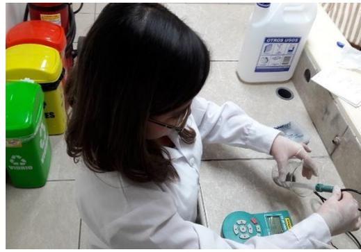
Medición del pH, temperatura y potencial redox en los ensayos de biolixiviación cada 7 días.
