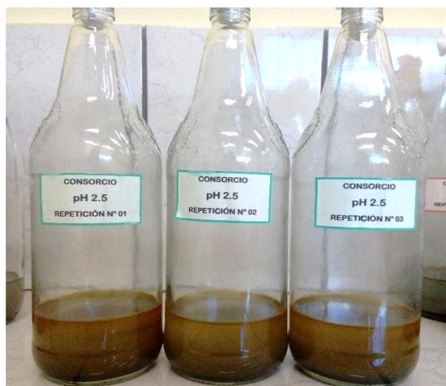
*Figura 32. Repeticiones de los tratamientos del proceso de biolixiviación a pH 2.5, presentando jarosita formada por la continua biooxidación.*
