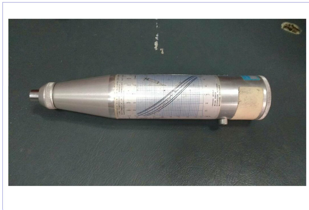
FOTO N° 10 EQUIPO ESCLERÓMETRICO PARA REALIZAR EN EL ENSAYO DEL MISMO Y DETERMINAR LA RESISTENCIA DE LOS ELEMENTOS ESTRUCTURALES
