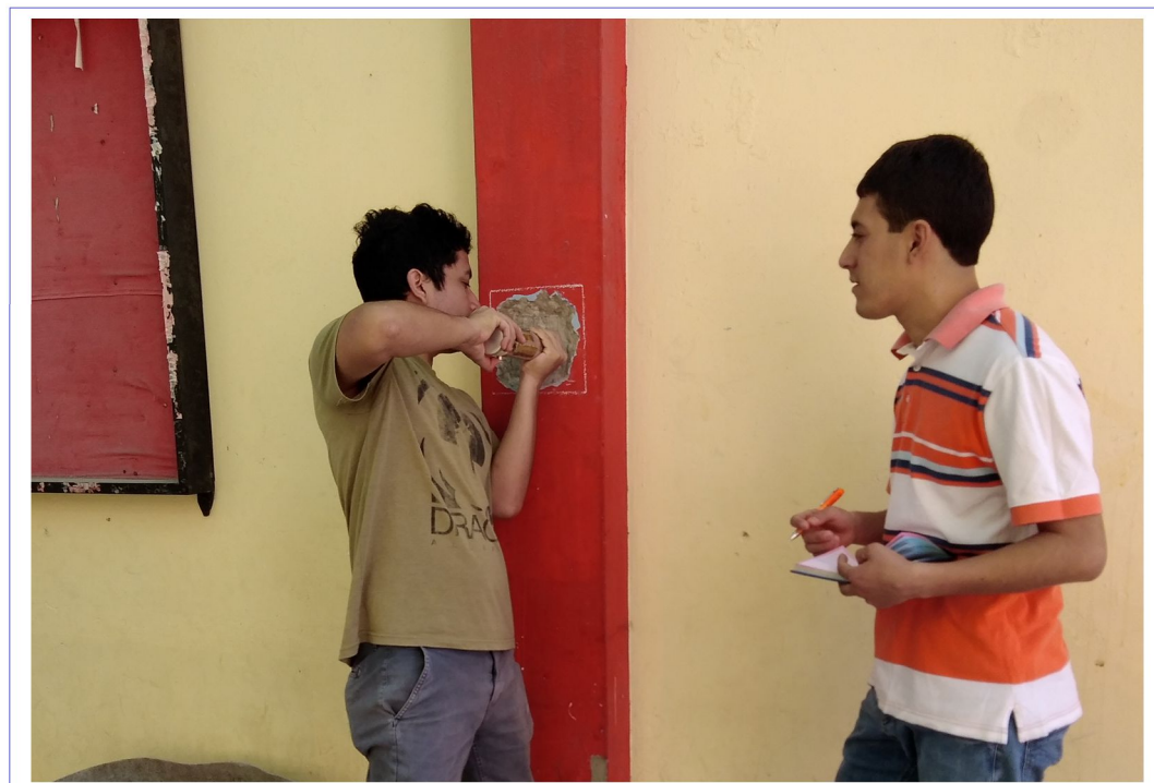
FOTO N° 16 TOMA DEL PRIMER ESCLERÓMETRO A 0° PERPENDICULAR A LA SUPERFICIE, EN COLUMNA
