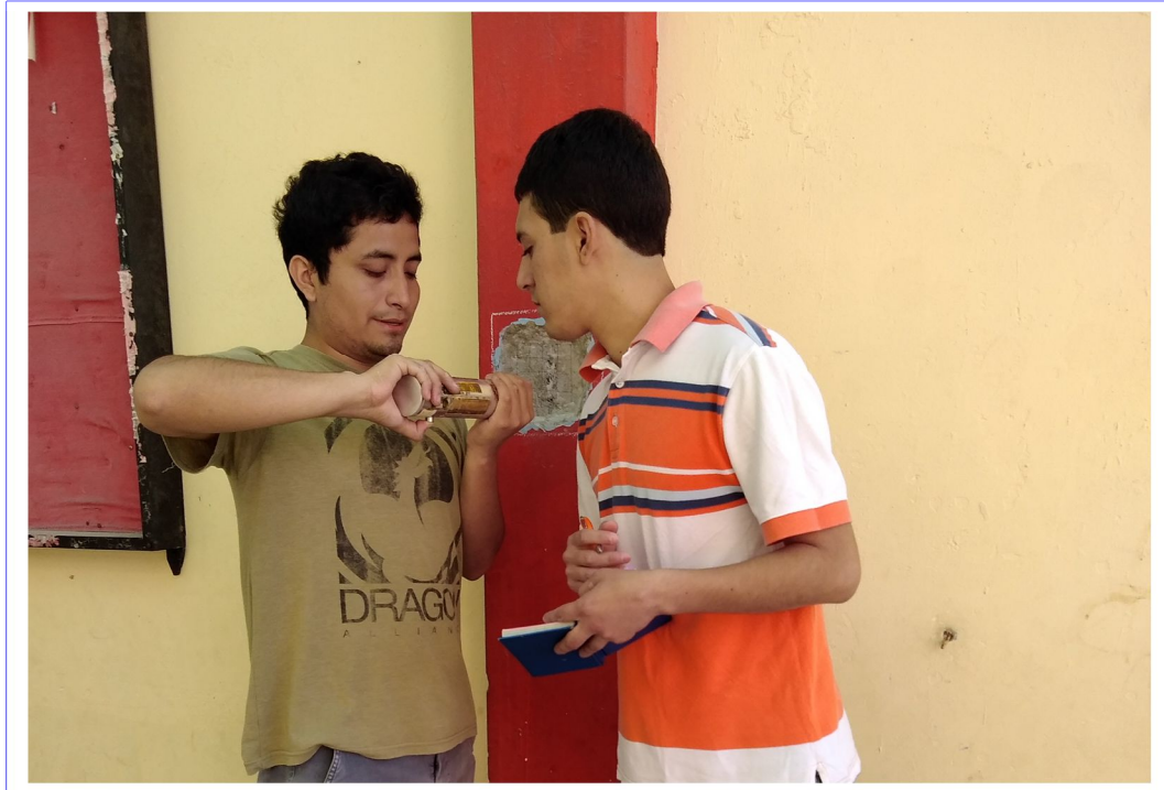
FOTO N° 17 DETERMINACIÓN DE LA RESISTENCIA SEGÚN EL ÍNDICE DE GOLPE OBTENIDO Y EL ÁBACO DEL EQUIPO
