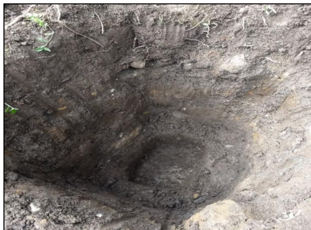
Figura 40 Calicata para realizar test de percolación
