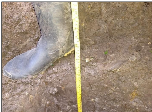
Figura 41 Vista de la medición de profundidad de calicata para test de percolación
