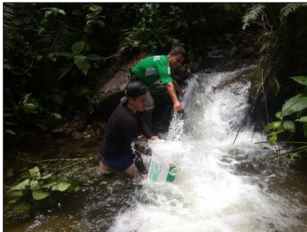
Figura 22 Aforamiento de la fuente Cajonhuayco
