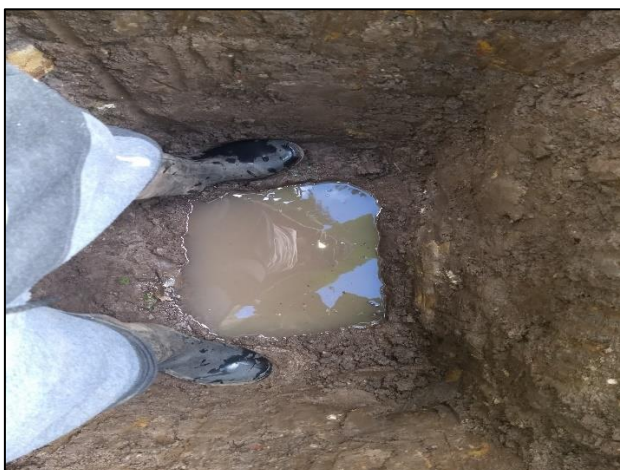
Figura 43 Calicata con agua para medir la velocidad de infiltración del suelo
