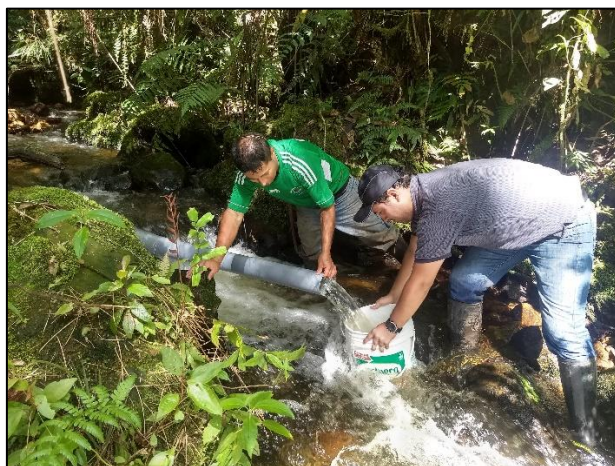
Figura 25 Aforamiento de la segunda fuente encontrada
