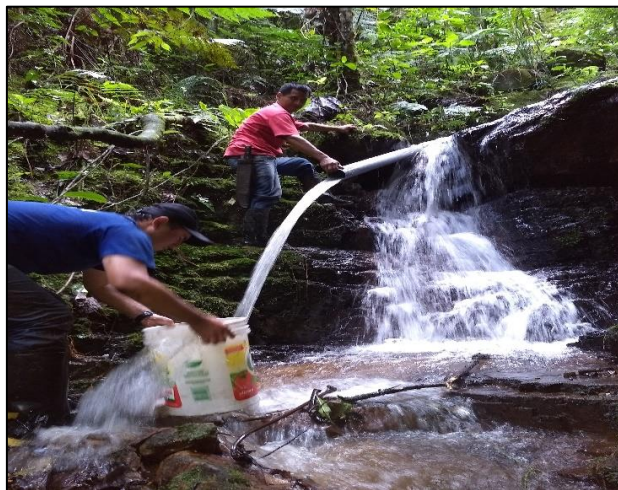
Figura 27 Aforamiento de la tercera fuente
