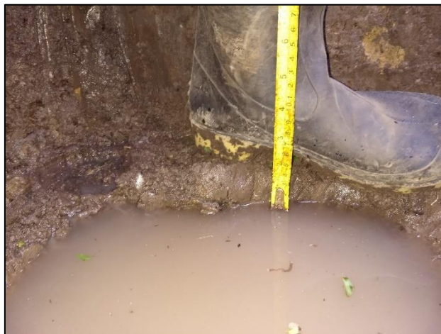
Figura 44 Vista de la medición de la calicata de test de percolación
