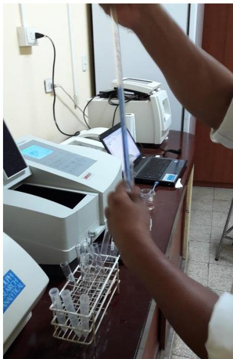
Figura 26: Determinación de Vitamina C en la pulpa de la tuna (*Opuntia boldinghii*) – agregando el 2,6 diclorofenol indofenol.
