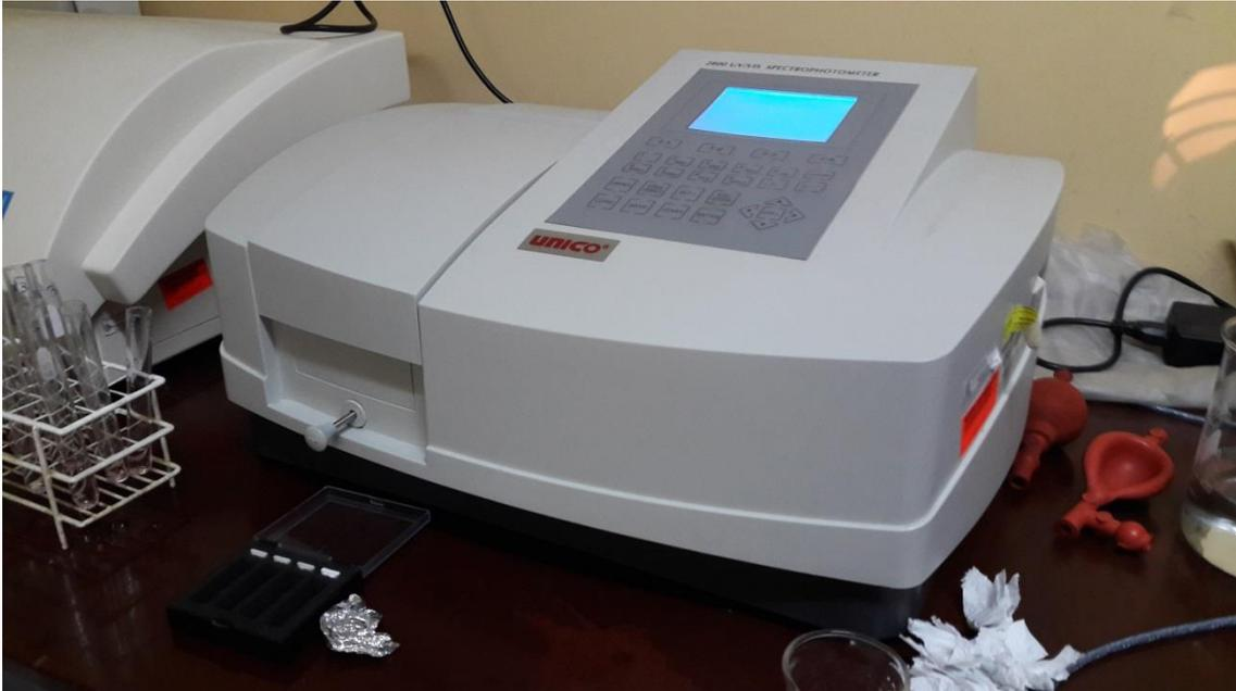
Figura 29: Determinación de Vitamina C en la pulpa de tuna (*Opuntia boldinghii*) – Espectrofotómetro UV.
