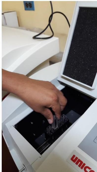
Figura 28: Determinación de Vitamina C en la pulpa de la tuna (*Opuntia boldinghii*) – colocando la cubeta con muestra.
