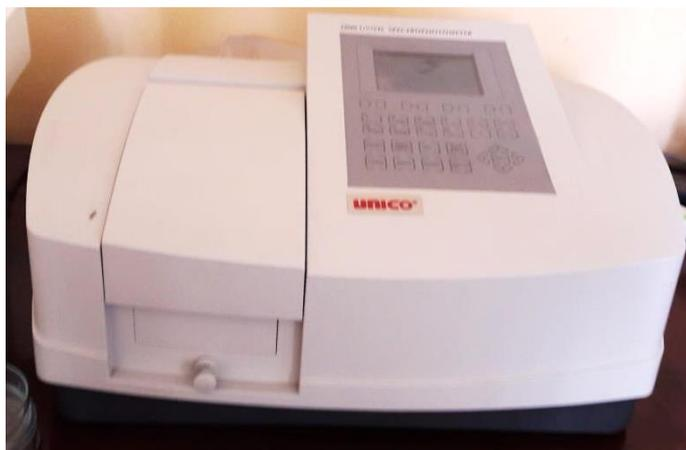
Figura 11: Espectrofotómetro Único 2800 UV-Vis
