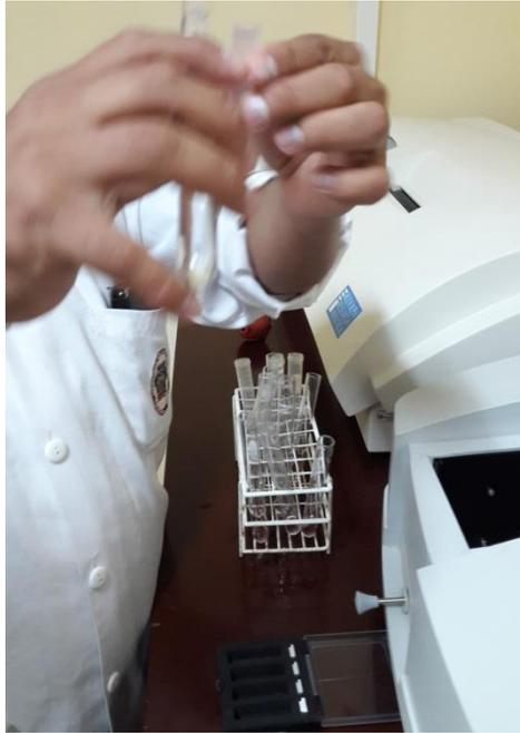
Figura 27: Determinación de Vitamina C en la pulpa de la tuna (*Opuntia boldinghii*) – agregando muestra a la cubeta.
