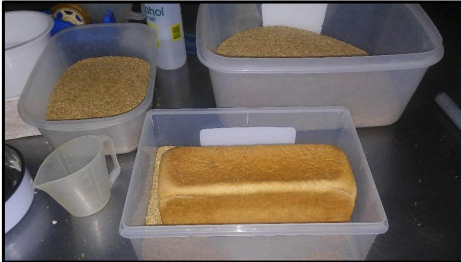
Figura 5. Evaluación del peso específico de los panes de molde utilizando la metodología de desplazamiento con semillas de alpiste.
