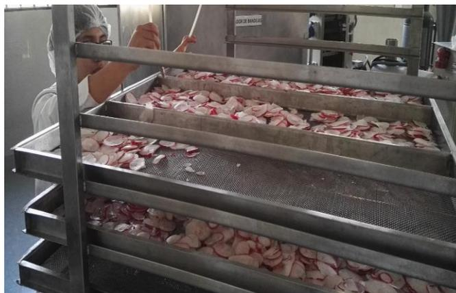
**Figura 37:** Secado de rabanitos con recubrimientos comestibles
