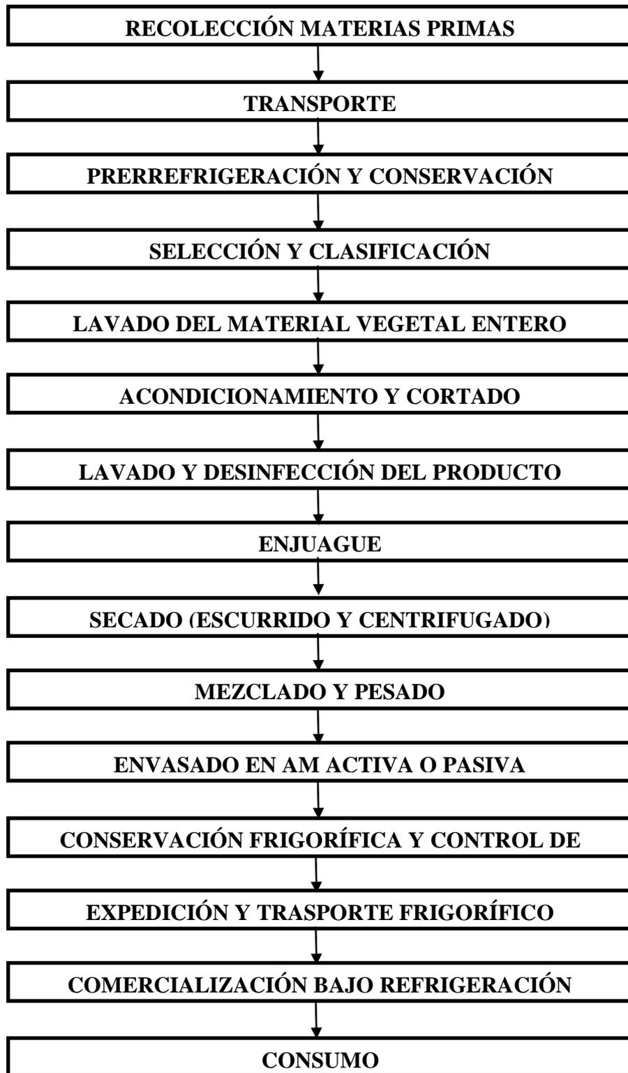
**Figura 16: Diagrama de flujo del proceso de elaboración de frutas y hortalizas frescas mínimamente procesadas**
