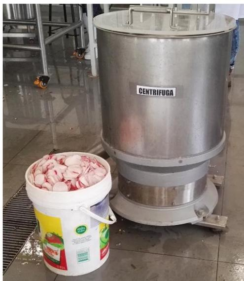
**Figura 33:** Eliminación del agua superficial mediante centrifuga industrial
