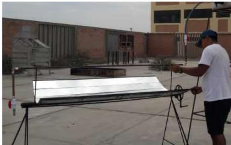
**Figura 23.** Concentrador solar orientado perpendicularmente a la posición del sol al medio día solar (12:00 h).
