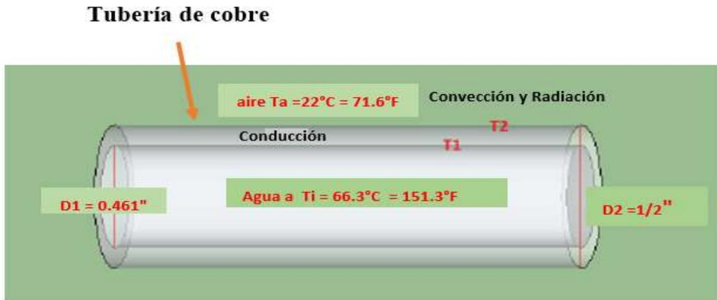
**Figura 18.** Perdidas por conducción, convección y radiación en la tubería.
