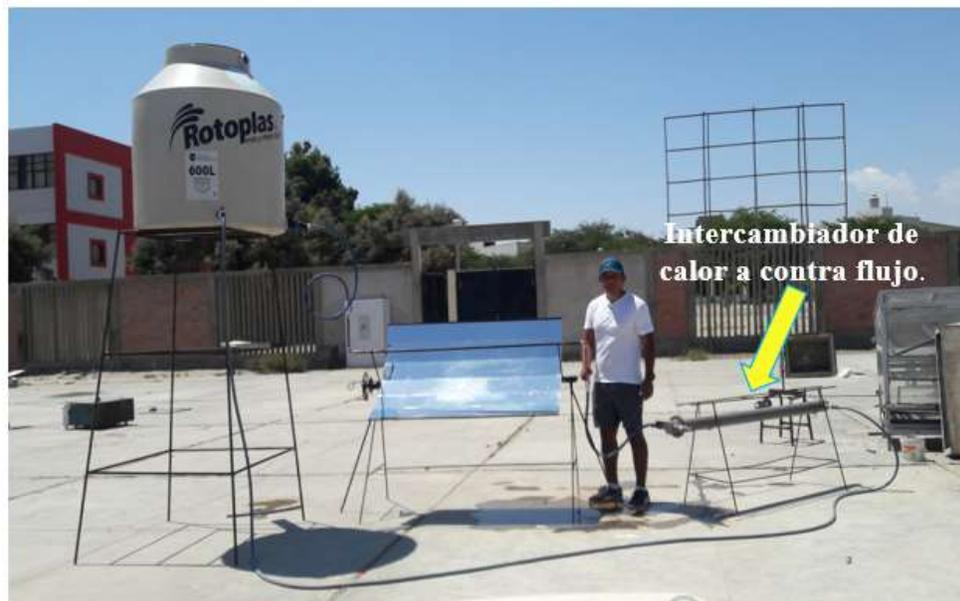
**Figura 19.** Intercambiador de calor a contraflujo
