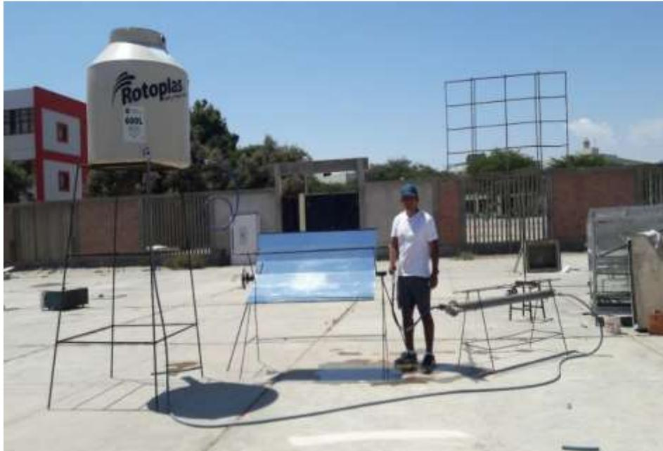
**Figura 25.** Concentrador solar cilíndrico parabólico acoplado al intercambiador de calor a contra flujo.
