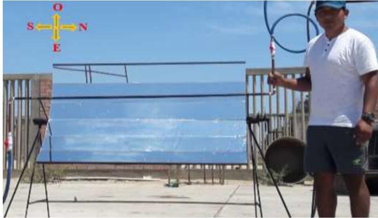
**Figura 22.** Concentrador solar orientado hacia el este.
