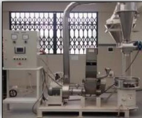
**Ilustración 8: Modulo de molienda y tamizado**
