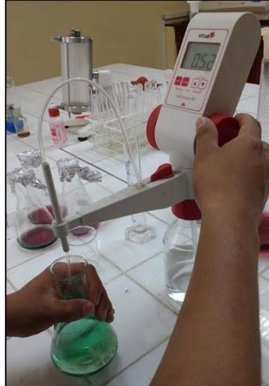
**Ilustración A-8: Titulación de muestra destilada**
