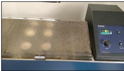
**Ilustración A-11: Colocación de frascos con muestras en baño maría 95 – 100°C**
