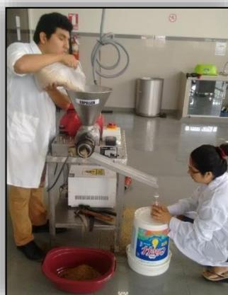
**Ilustración 14: Extracción del Aceite y Obtención de la harina de ajonjolí desgrasada.**
