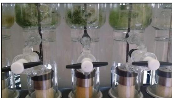
**Ilustración A-9: Extracción de grasa de las muestras**
