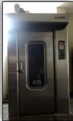
**Ilustración 11: Horno Rotatorio**
