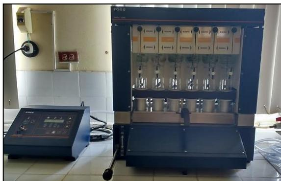
**Ilustración A-5. Equipo de determinación de grasa: Soxhlet**
