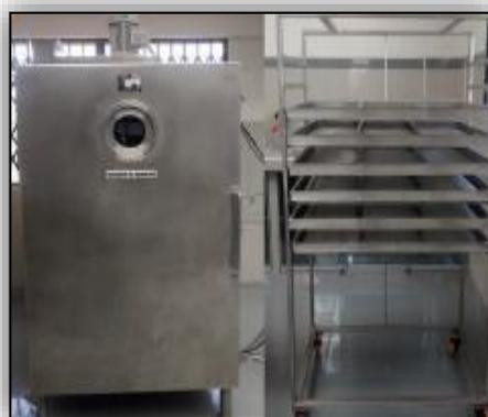
**Ilustración 6: Secador de Bandejas**
