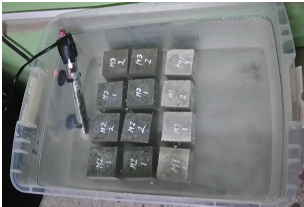
Ilustración 61 Curado de probetas del microclima MC3-Geotextil. (Procedimiento constructivo del tesista).
