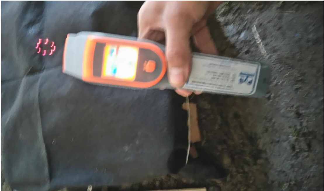
Ilustración 42 Termómetro laser (procedimiento constructivo del tesista).
