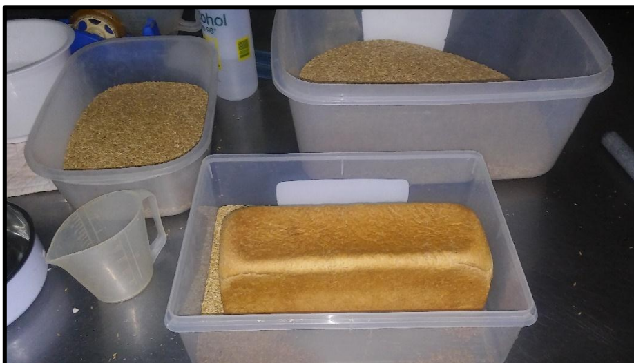
Figura 54. Evaluación del peso específico de los panes de molde utilizando la metodología de desplazamiento con semillas de alpiste.
