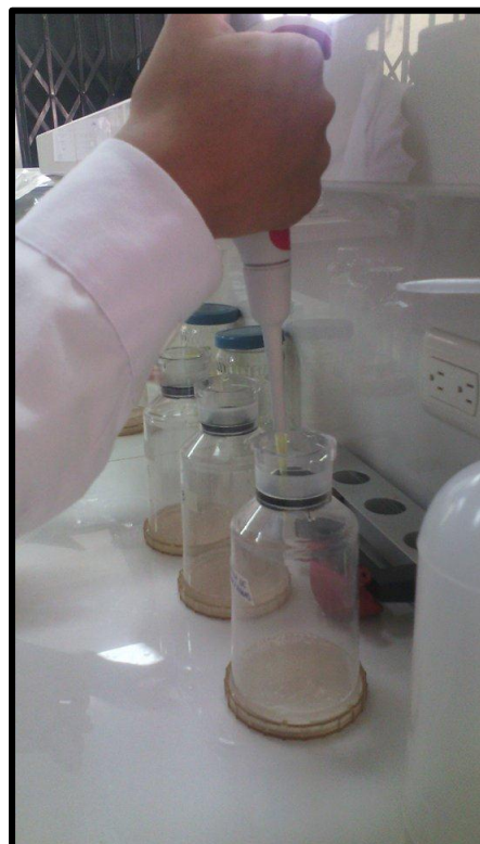
Figura 110. Uso de la pipeta para agregar la enzima en los vasos que contienen las muestras.
