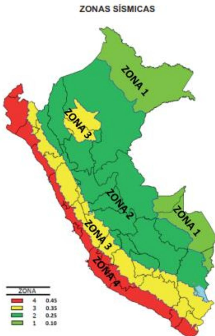
**Figura 9. Zonas sísmicas según norma Sismoresistente e.030**
