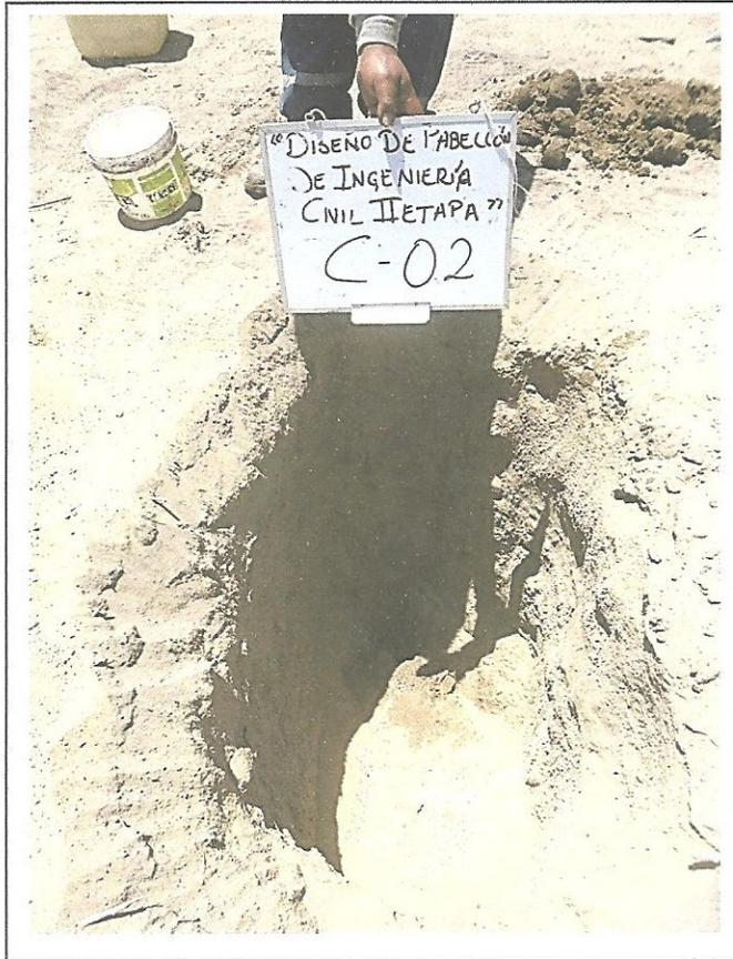
**Foto N°03:** Vista de la calicata C-02, presencia de arena limosa con raíces en la superficie. De 0.20 a 4.20m presencia de arena mal graduada (SP), medianamente compacto a compacto, seco a ligeramente húmedo de color beige claro.
