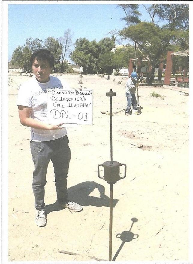
**Foto N°05:** Vista de ubicación del DPL-01, presencia de arena limosa con raíces en la superficie. De 0.40 a 4.10m presencia de arena mal graduada (SP), medianamente compacto a compacto, seco a ligeramente húmedo de color beige claro.
