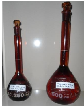
Figura 28. Tiosulfato de sodio 0.01N (derecha), tiosulfato de sodio 0.1N (izquierda).
