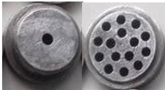
Boquilla de trabajo del extrusor doble tornillo modelo LABOR PQ DRX-50
