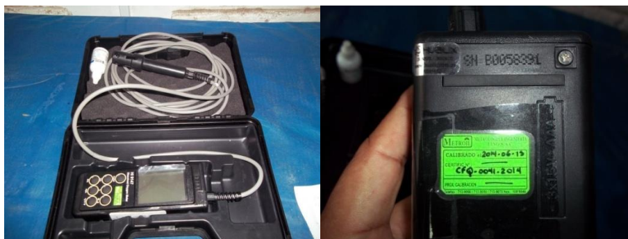
Fig 3. Equipo de inspecciones: oxímetro calibrado.
