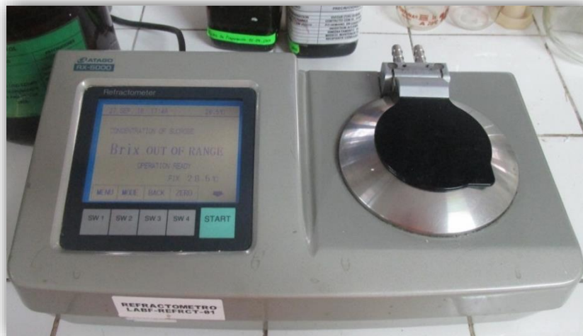
Figura 15: Refractómetro digital, marca: ATAGO/Modelo: RX5000
