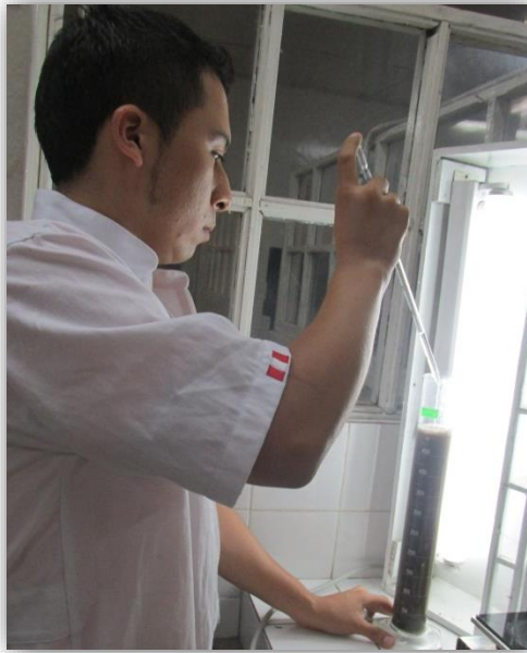
Figura 27: Agregando las dosis de los floculantes (3, 6 y 9 ppm).
