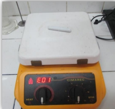
Figura 17: Plancha de calentamiento múltiple con agitación magnética/modelo: AM4
