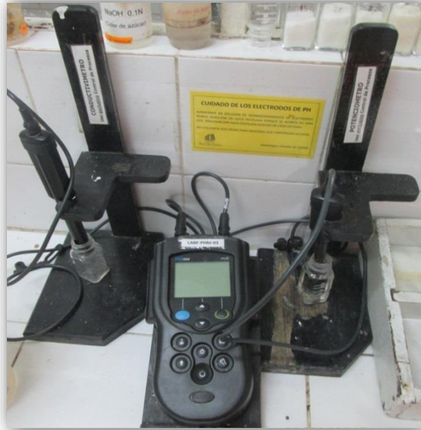
Figura 14: Multiparámetro digital, marca: HACH / modelo: HQD40
