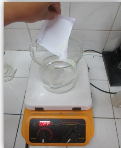
Figura 23: Agregando los 35 gr. de floculante.
