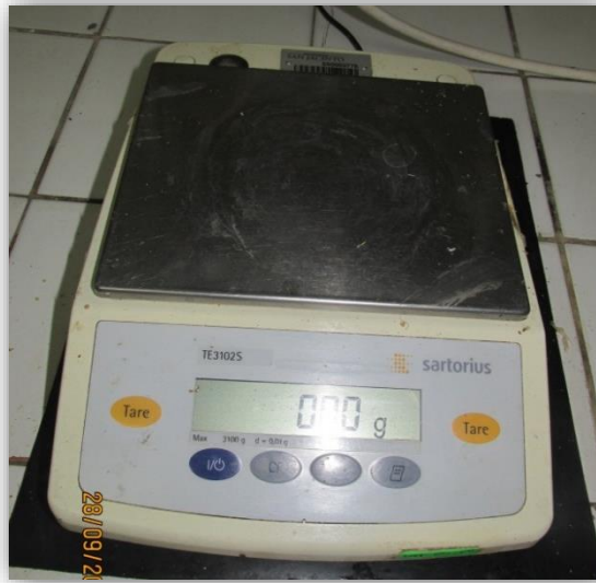
Figura 18: Balanza de precisión, marca: SARTORIUS / Modelo: TE3102S
