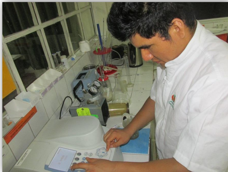
Figura 33: Lectura de la absorbancia en determinación de color y turbidez.
