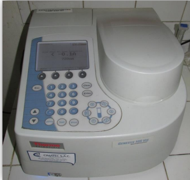
Figura 16: Espectrofotómetro digital, Marca: THERMO SCIENTIFIC/Modelo: Genesis 10S VIS
