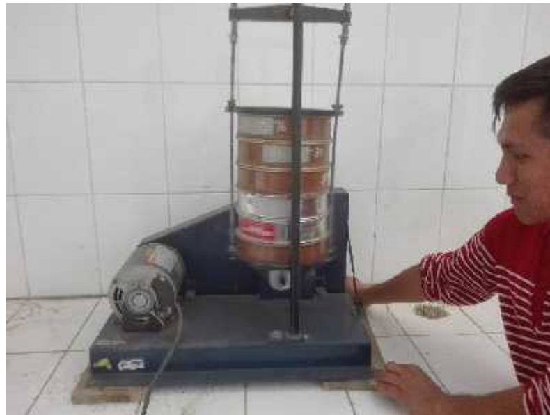
Foto N°07: Se realizó el análisis granulométrico en el tamizador eléctrico del confitillo y de la arena gruesa para ver si el material es óptimo y cumple con la norma E-070, para la elaboración de los ladrillos .
