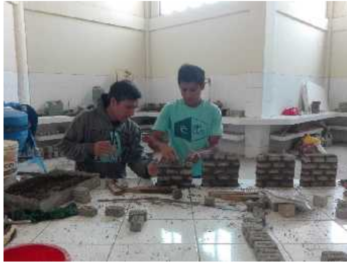
Foto N°41: Se elaboraron muretes a escala 1:3 para la obtención de la resistencia al corte.
