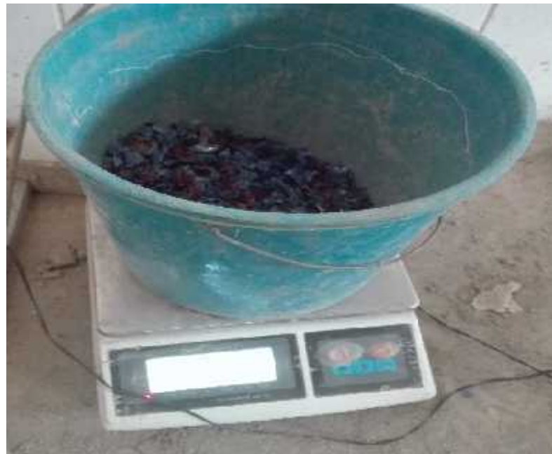
Foto N°20: El peso del plástico se realizó en porcentaje al peso del cemento.
