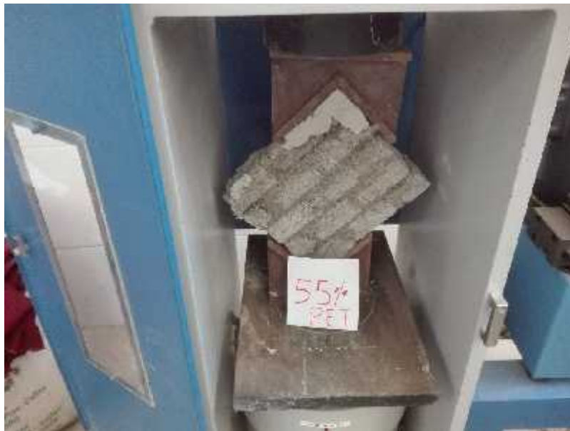
Foto N°44: Ensayo de resistencia al corte de muretes de aproximadamente 20 cm x 20cm a escala 1:3.
