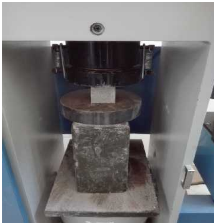
Foto N°30: Ensayo de resistencia a la compresión 140 \text{ kg/cm}^2 a los 28 días.
