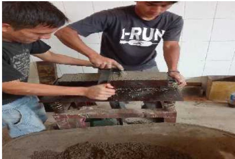
Foto N°17: Obtenida la mezcla se procedió a colocarla dentro de un molde metálico, por capas conforme se iba vibrando y compactando aproximadamente unos 40 segundos.
