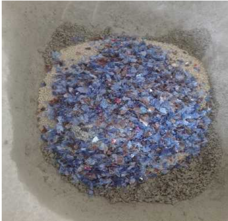
Foto N°21: Se realizó el mezclado de la arena, el confitillo y el cemento adicionándole el Pet.
