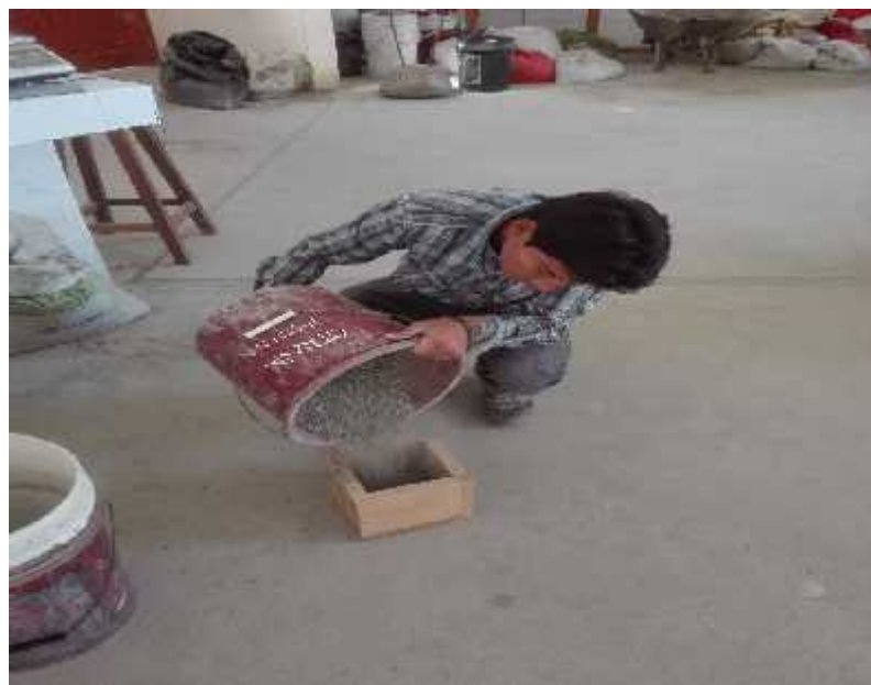
Foto N°12: Se realizaron los ensayos del peso volumétrico suelto del agregado grueso y agregado fino.
