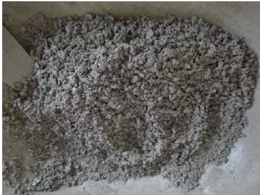
Foto N°16: Se fue agregando el agua poco a poco y batiendo la mezcla hasta obtener la textura deseada durante 5 minutos.
