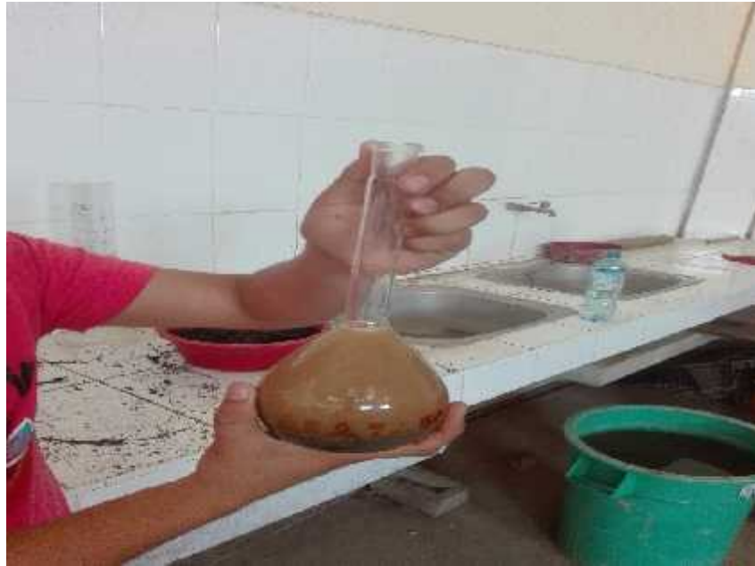
Foto N°09: Se colocó la arena gruesa en la fiola para luego calcular la densidad.
