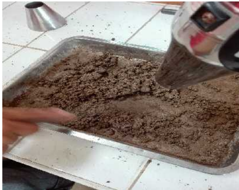
Foto N°10: Secado superficial de la arena gruesa saturada.
