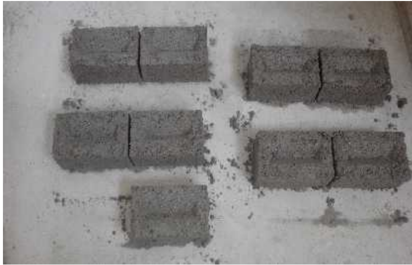
Foto N°23: Tendido de las unidades de albañilería para el fraguado.
