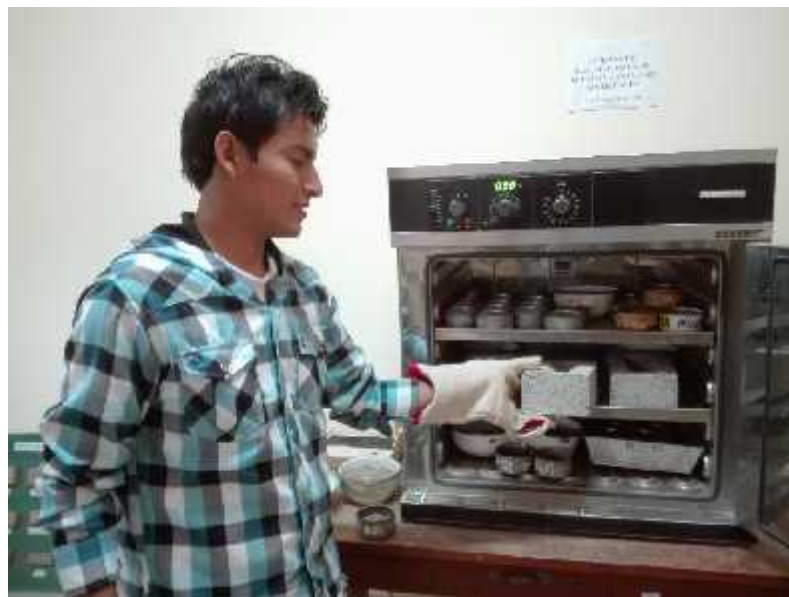
Foto N°34: Se realizó el ensayo de contenido de humedad a las unidades de albañilería.
