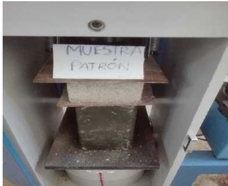
Foto N°31: Rotura de los ladrillos Patrón y ladrillos con Pet para encontrar la resistencia a la compresión.
