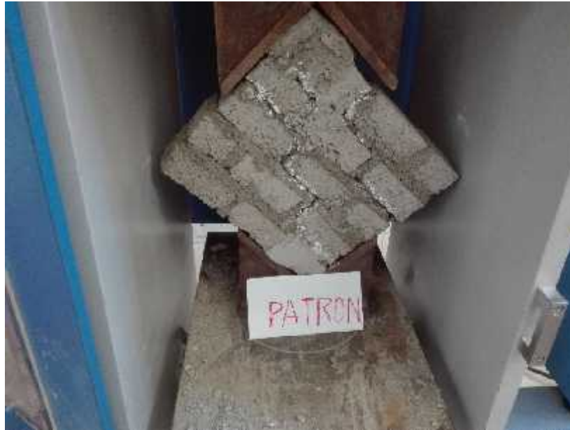
Foto N°45: Se visualiza la falla de ruptura del murete pintada de blanco.
