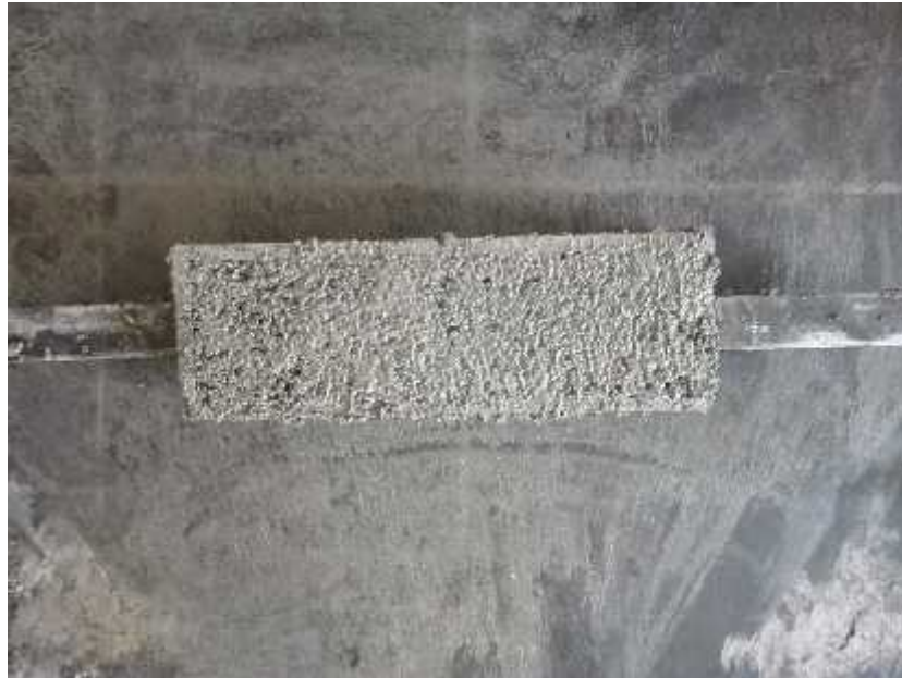
Foto N°25: La elaboración de los ladrillos a escala fue realizado con las mismas dosificaciones del ladrillo Patrón y del ladrillo con Pet a escala natural, siguiendo el mismo procedimiento.
