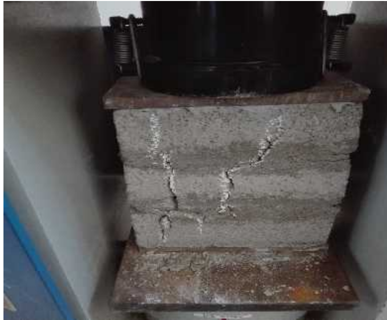
Foto N°43: Falla de ruptura de la pila elaborada con ladrillo Patrón.
