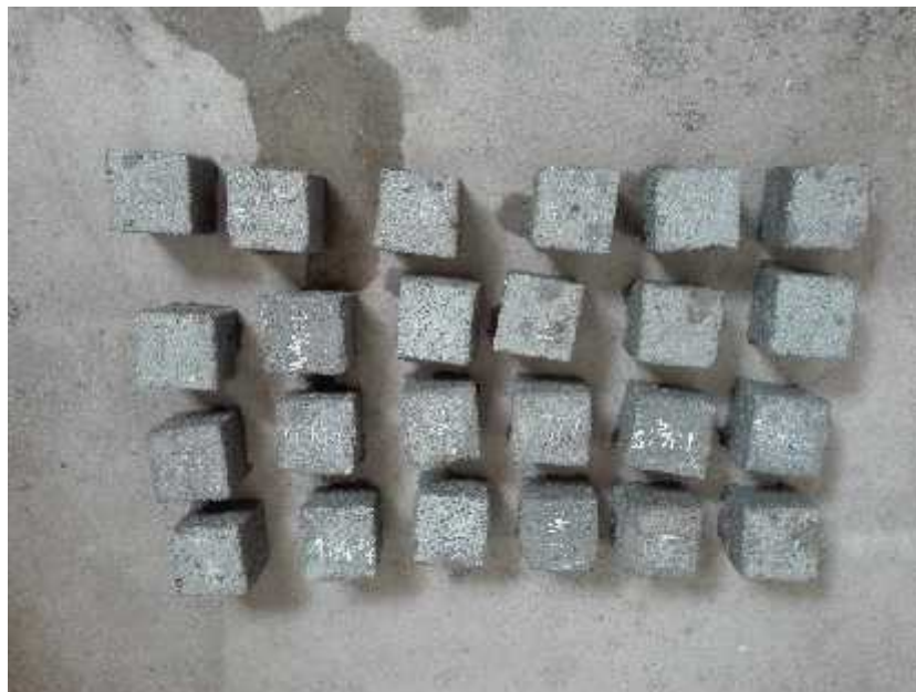
Foto N°28: Elaboración de cubos de mortero.
