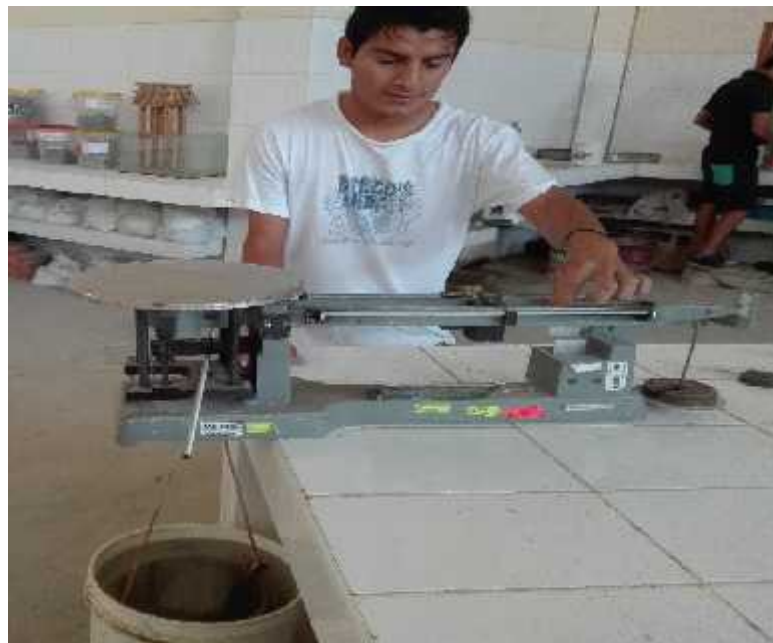
Foto N°38: Se pesó las unidades sumergidas para el cálculo de la densidad.
