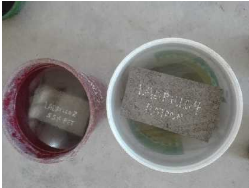
Foto N°35: Se colocaron los ladrillos en un balde con agua por 24 horas para calcular el porcentaje de absorción.
