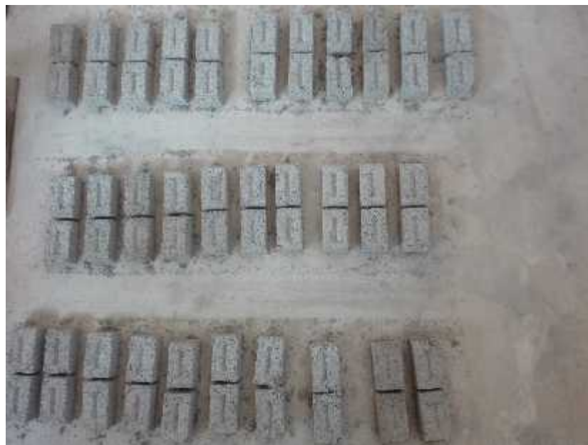
Foto N°26: Se realizaron 60 unidades a escala, con la dosificación del ladrillo Patrón y 60 unidades con el 55% de Pet, para la fabricación de los muretes.
