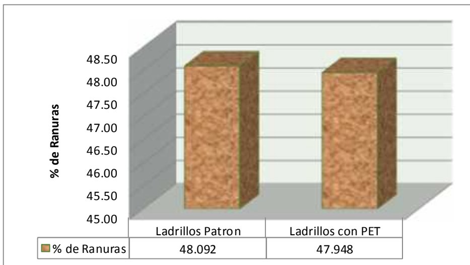
Gráfico N° 22. Comparación del Porcentaje de Ranuras en Ladrillos Patrón y Ladrillos con PET
