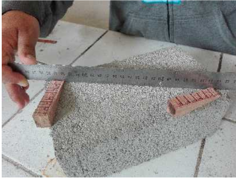
Foto N°33: Se realizó el ensayo de alabeo a los ladrillos, sin presentar alabeo las unidades.
