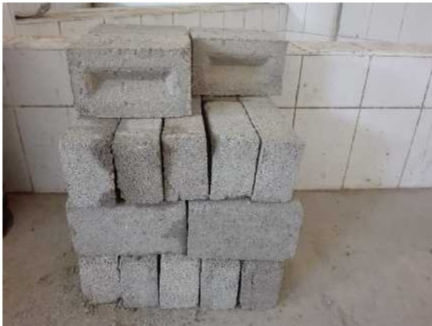
Foto N°24: Almacenamiento de los ladrillos diseñados al 35%, 45%, 55% y al 100% de Pet en relación al cemento.
