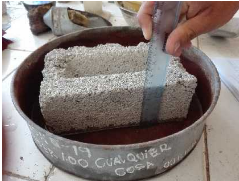
Foto N°37: Se realizó el ensayo de succión a los ladrillos en una bandeja de agua, por 1 minuto, posteriormente se retiró y se pesó.
