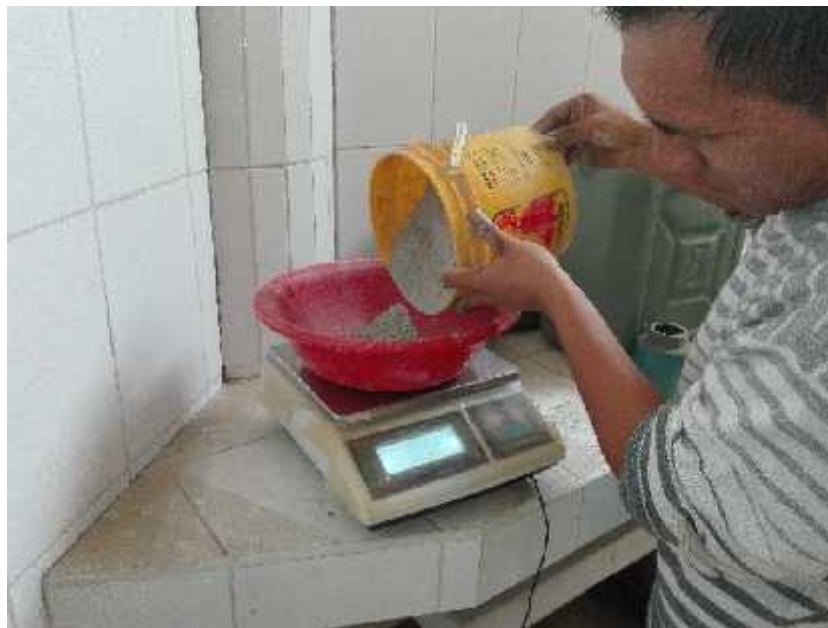
Foto N°14: La dosificación 1:7:3 ( cemento, arena, confitillo), de los materiales se realizó en función al peso.
