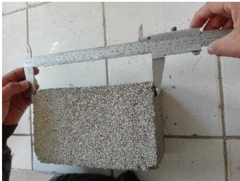
Foto N°32: Ensayo de variación dimensional se realizó con un vernier para obtener los datos más exactos.
