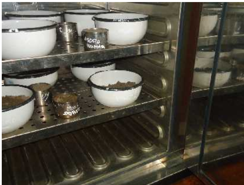
Foto N°08: Se calculó el contenido de humedad de los agregados ( grueso y fino).
