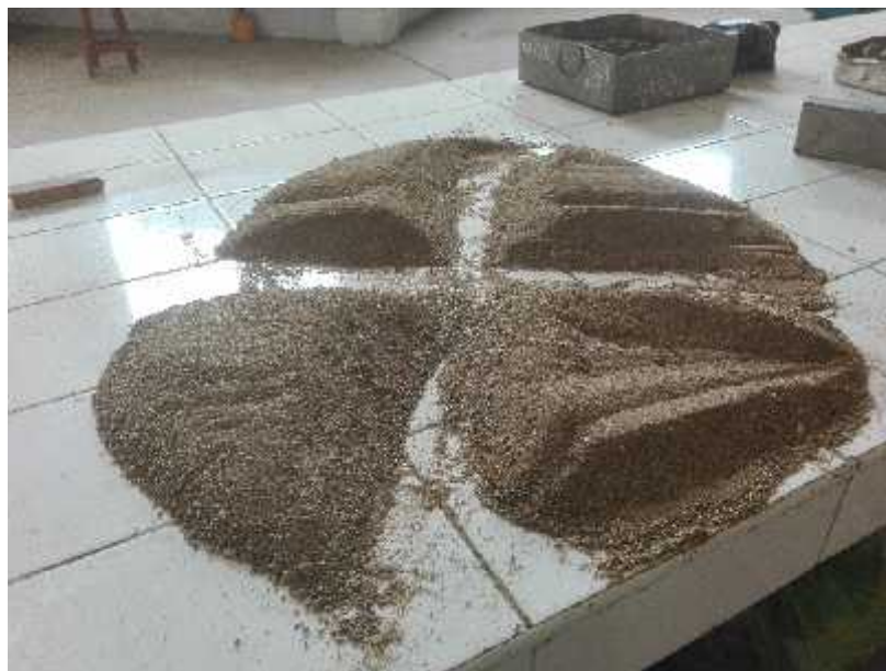
Foto N°06: Proceso de selección de la muestra representativa del agregado fino (Arena Gruesa) mediante el ensayo de cuarteo.
