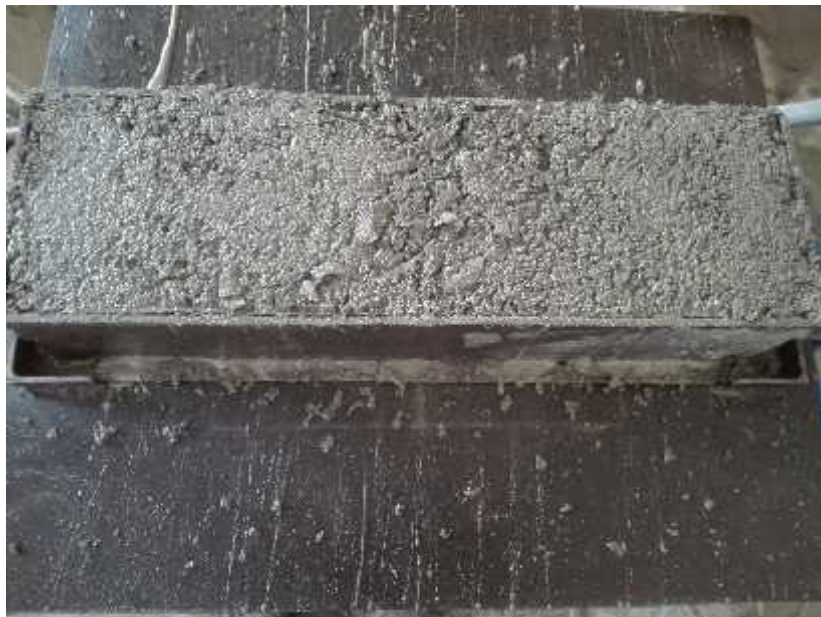
Foto N°22: Moldeado y compactado con la vibración las unidades de albañilería.
