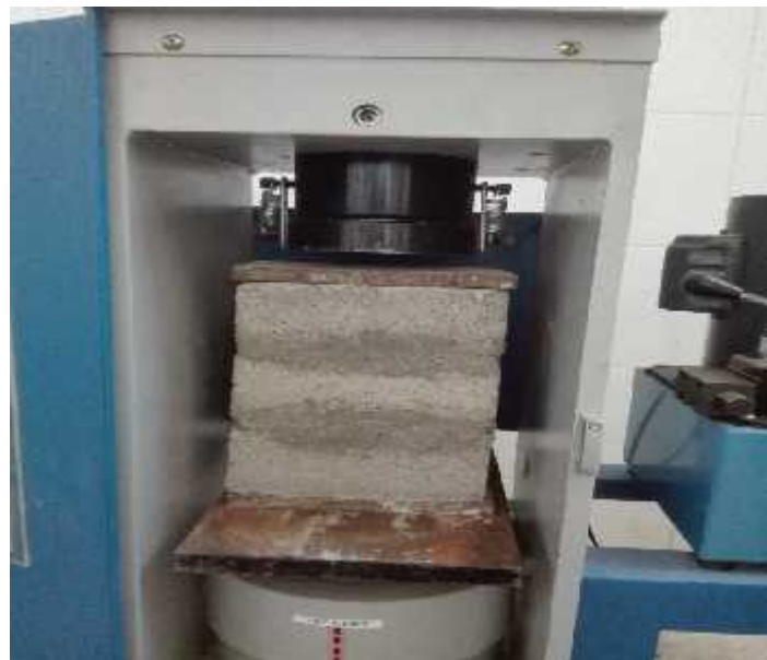
Foto N°42: Se realizó el ensayo de pilas para el ladrillo patrón y el ladrillo adicionado Pet, con la finalidad de calcular el esfuerzo a la compresión axial, a los 28 días de su elaboración.
