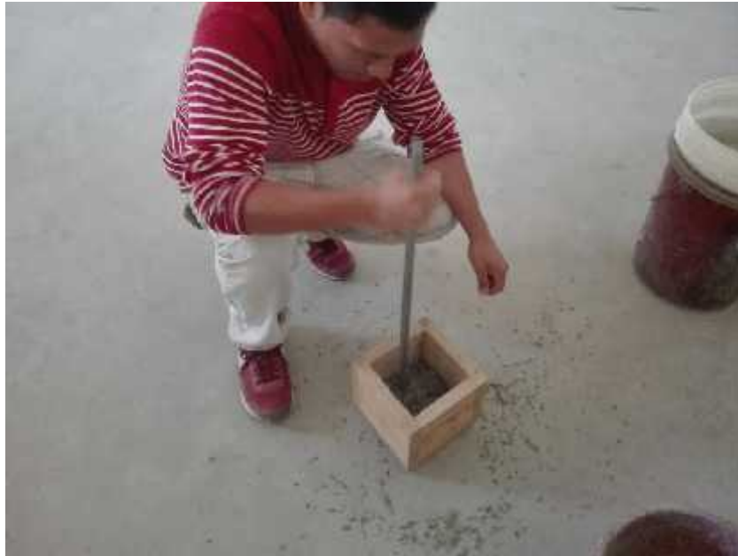
Foto N°13: Se realizaron los ensayos del peso volumétrico compactado del agregado grueso y agregado fino.
