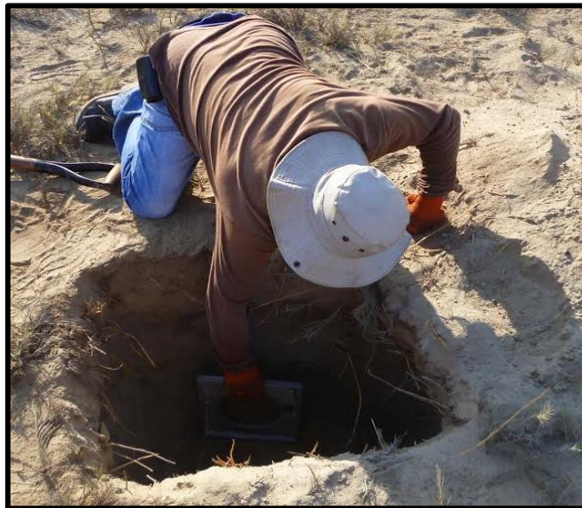
Calicata de 1.50 para la extracción de la muestra de suelo
