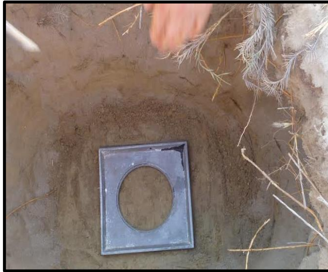
Extracción de la muestra de suelo para la densidad de campo
