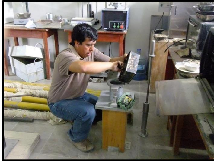
**Fotografía 4-8 Fabricación de una briqueta, llenado del molde para compactar con el Martillo**
