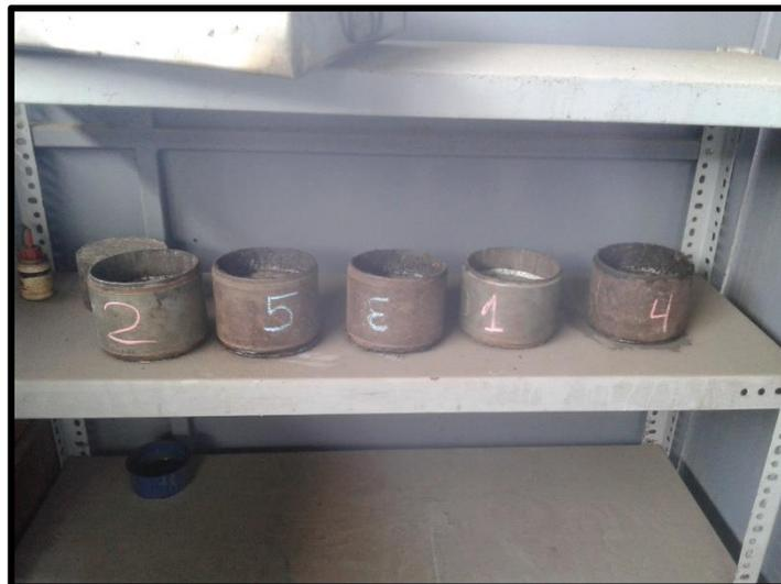
**Fotografía 4-9 Muestras Compactadas en los Moldes para Briquetas con los materiales granulares**
