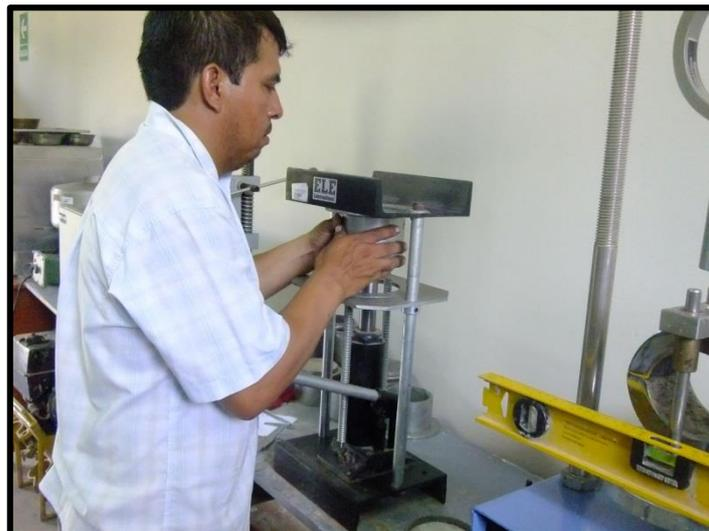
**Fotografía 4-11 Equipo para Desmolde de Briquetas y Muestras Desmoldadas**
