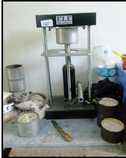
**Fotografía 4-5 Equipos Utilizados en la extracción de Briquetas por el Método Marshall**
