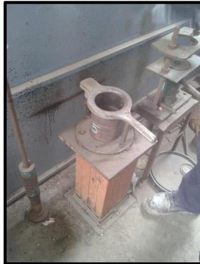
**Fotografía 4-4 Equipos Utilizados en la Compactación de Briquetas por el Método Marshall**
