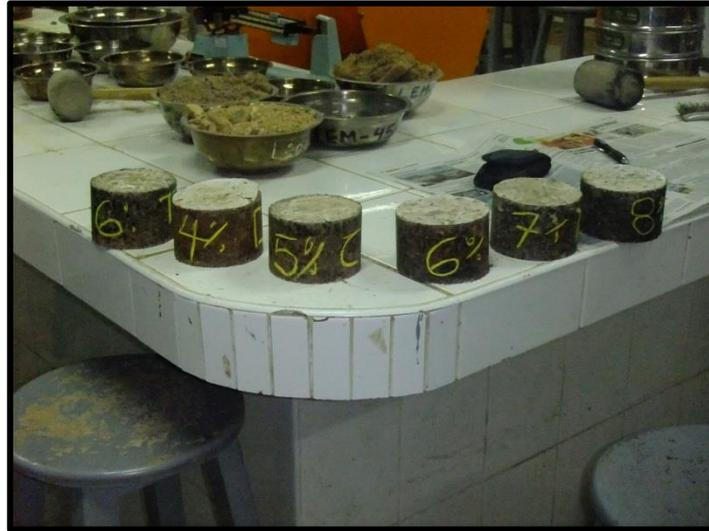
**Fotografía 4-13 Señalización de Marcas para Medición de Dimensiones**
