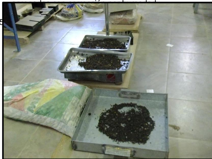
**Fotografía 4-2 Pesaje de Agregados para Ensayo de Recubrimiento.**
