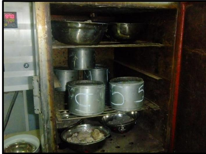
**Fotografía 4-10 Curado de Muestras en Moldes para Briquetas en Horno**
