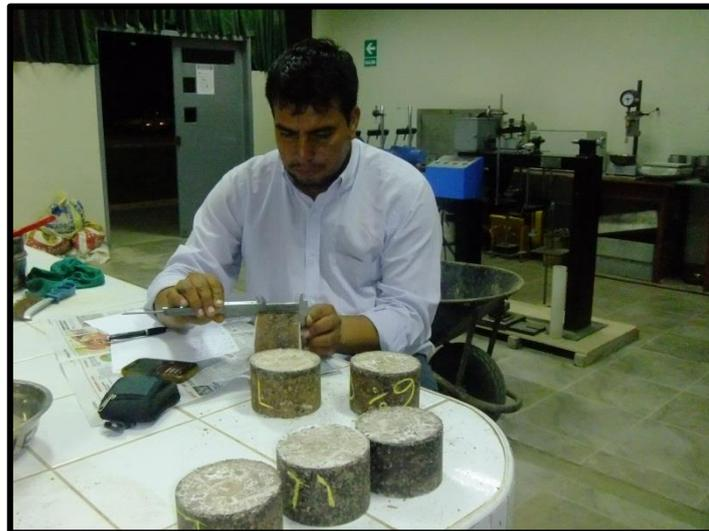
**Fotografía 4-12 Equipo utilizado para la determinación de Propiedades Volumétricas**
