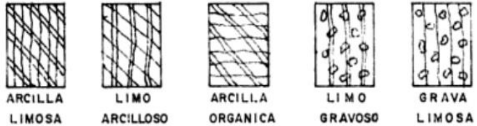
Figura N° 2: REPRESENTACION DEL SUELO Fuente: Mecánica de suelos y cimentaciones (Crespo,2004)
