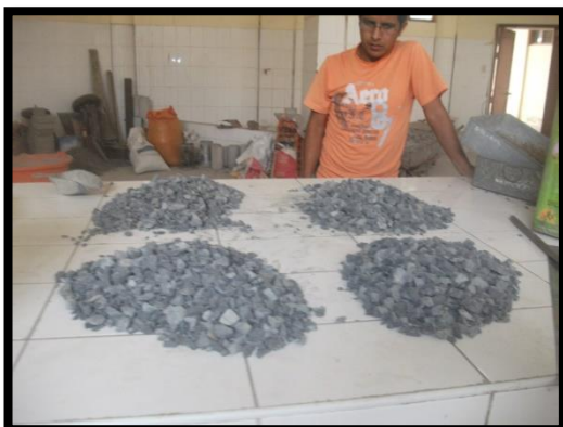
Foto 13. Cuarteo del Agregado Grueso
