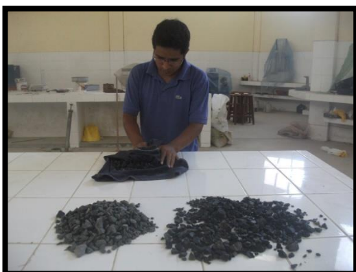
Foto 15. Absorción del Agregado Grueso
