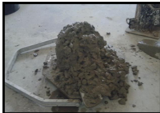
Foto 28. Slump del concreto
