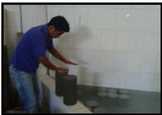
Foto 31. Curado de las Probetas de Concreto
