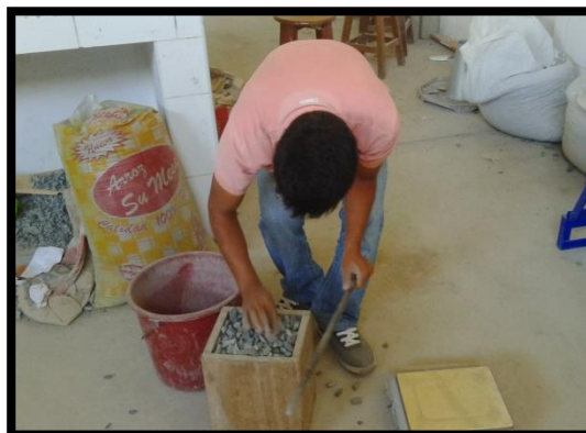
Foto 14. Pesos Unitarios del Agregado Grueso
