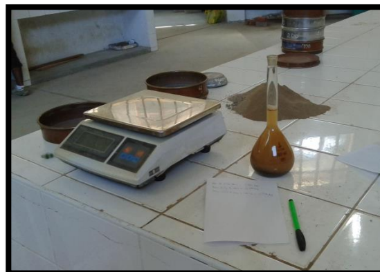
Foto 20. Peso Específico de la Arena Gruesa
