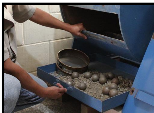
Foto 18. Agregado Grueso después de haber cumplido las 500 vueltas
