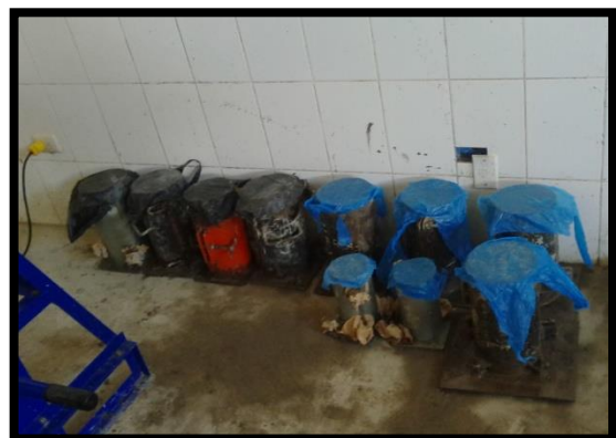
Foto 30. Probetas cubiertas para evitar la evaporación del agua
