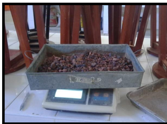
Foto 12. Ladrillo Rococho Retenido en la Malla N°12
