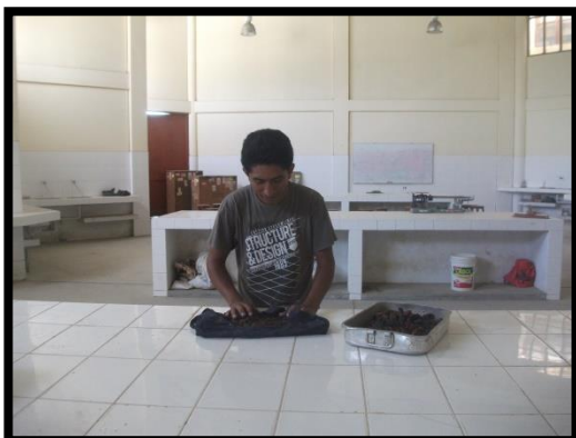
Foto 7. Absorción del Ladrillo Rococho
