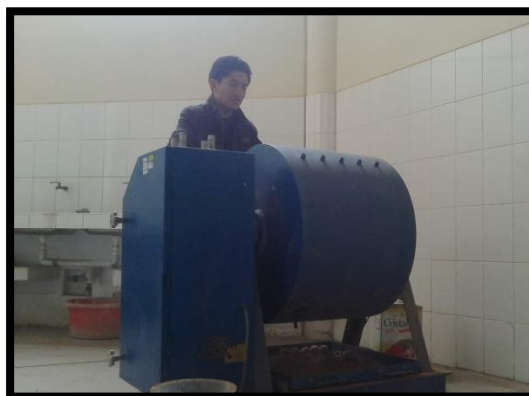
Foto 10. Ensayo de Abrasión del ladrillo Rococho
