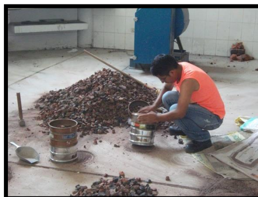
Foto 4. Tamizado del Ladrillo Rococho
