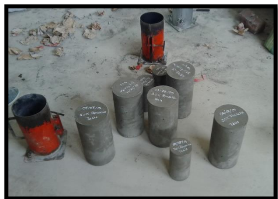
Foto 32. Desencofrado de Probetas
