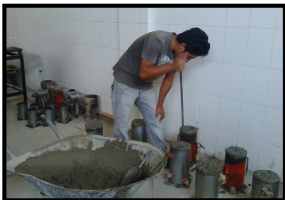
Foto 29. Chuseado de probetas de concreto
