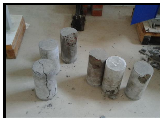
Foto 37. Probetas después del ensayo a compresión
