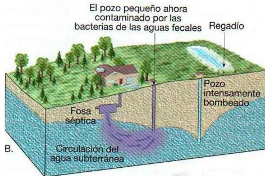
Figura N°13 B. El intenso bombeo del pozo cambió la pendiente del nivel freático, haciendo que el agua subterránea contaminada fluyera hacia el pozo pequeño.
