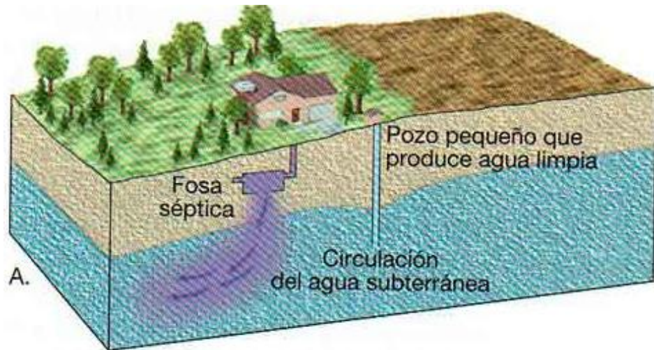
Figura N°13 A. Originalmente el flujo de salida de la fosa séptica se alejaba del pozo pequeño.
