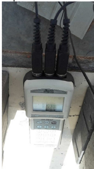
Figura N° 48. Data Logger para medir temperaturas durante el experimento. (Fuente: Propia, 2016)
