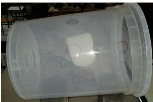
Figura N° 53. Señalización en donde irán el tubo, los cables y el punto de admisión del agua. (Fuente: Propia, 2016).
