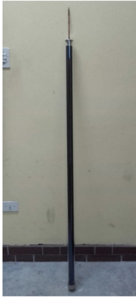
Figura N° 65. Tubo de vacío de alta presión con sellado de silicona de motores para evitar la fuga del agua del tanque. (Fuente: Propia, 2016)
