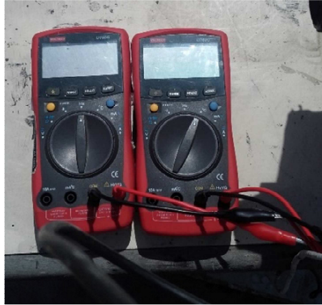
Figura N° 47. Multímetros para medir resistencia de los termistores. (Fuente: Propia, 2016)
