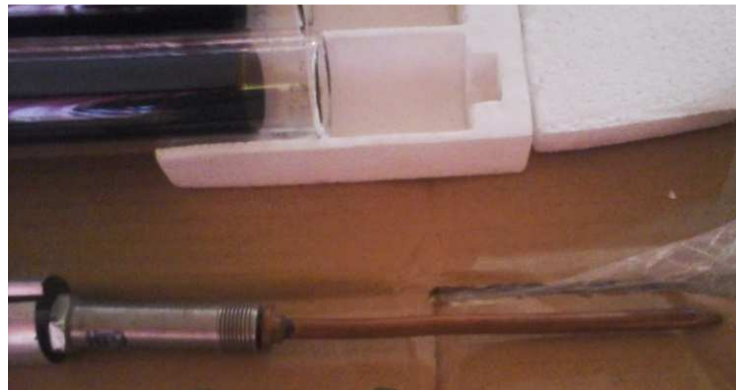
Figura N° 63. Tubo de calor de un tubo de vacío de alta presión. (Fuente: Propia, 2016)
