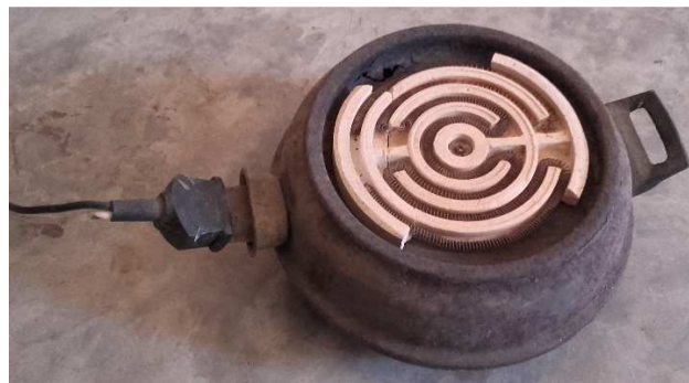
Figura N° 46. Cocina eléctrica utilizada para calibración de termistores. (Fuente: Propia, 2016).
