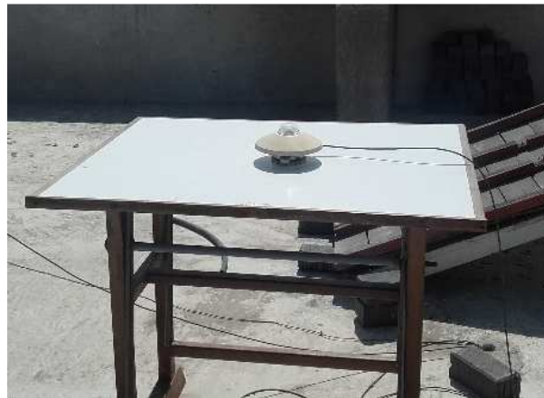
Figura N° 68. Piranómetro para medir radiación global. (Fuente: Propia, 2016)
