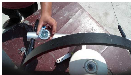
Figura N° 71. Orientación del arco disco, el cual está en los ejes Este-Oeste. (Fuente: Propia, 2016)
