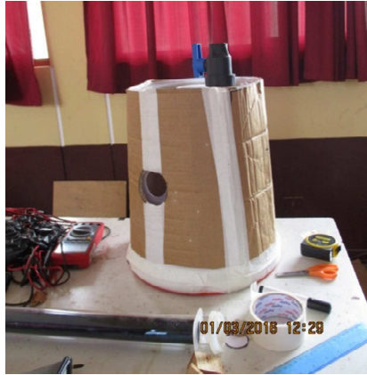
Figura N° 56. Tanque recubierto con cartón. (Fuente: Propia, 2016)
