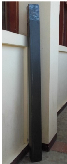
Figura N° 43. Cubierta para evitar que la radiación incida sobre el tubo de vacío. (Fuente: Propia, 2016)
