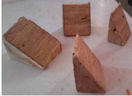
Figura N° 41. Tacos de madera para fijar el tanque de almacenamiento. (Fuente: Propia, 2016)
