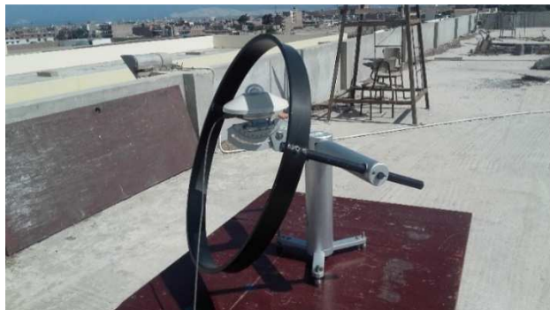
Figura N° 69. Piranómetro con arco disco para medir radiación difusa. (Fuente: Propia, 2016)
