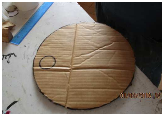
Figura N° 55. Marcación de corte del recubrimiento del tanque. (Fuente: Propia, 2016)
