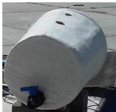
Figura N° 58. Tanque aislado. (Fuente: Propia, 2016)
