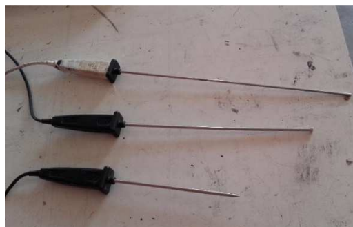
Figura N° 49. Termocuplas para medir temperaturas del agua y ambiente. (Fuente: Propia, 2016)
