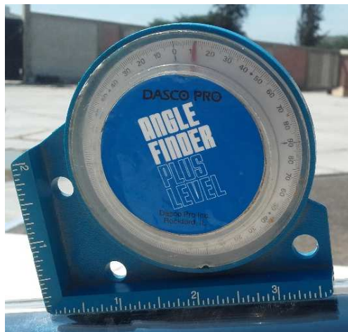
Figura N° 51. Inclinómetro para medir inclinación del tubo y del anillo de sombreado (Fuente: Propia, 2016)
