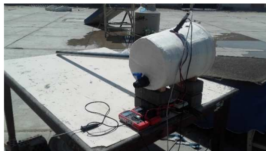
Figura N° 62. Adecuación o montaje del tubo de vacío de baja presión. (Fuente: Propia, 2016)
