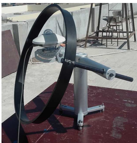
Figura N° 17. Piranómetro con sombreado de anillo para captar la radiación difusa. (Fuente: Propia, 2016).
