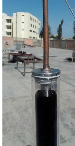
Figura N° 65. Tubo de vacío de alta presión con sellado de silicona de motores para evitar la fuga del agua del tanque. (Fuente: Propia, 2016)
