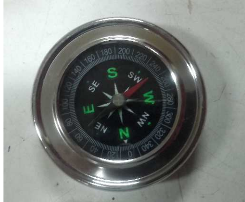
Figura N° 50. Brújula para orientar sistema experimental y anillo de sombreado. (Fuente: Propia, 2016)
