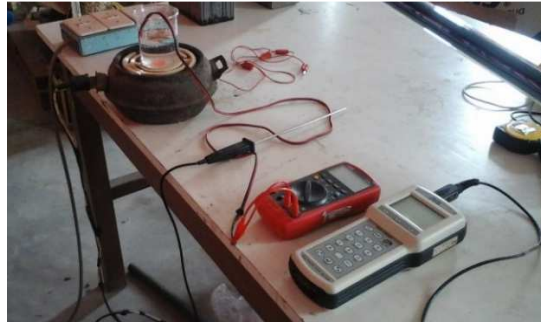
Figura N° 59. Calibración de los termistores. (Fuente: Propia, 2016)
