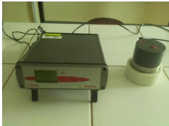
Figura 14: HIDROLAB, marca Rotronic, modelo Aw – Dio
