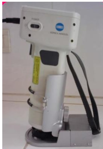
Figura 12: Colorímetro Chroma Meter: Marca Konica Minolta Modelo Cr – 400, Japan
