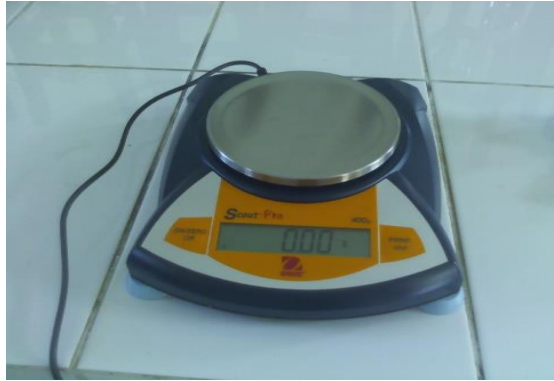
Figura 16: Balanza Analítica. Ohaus Scout Pro, balanza con RS232
