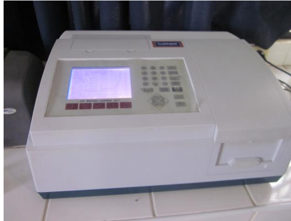
Figura 11: Espectrofotómetro Uv, Marca Turner – Barnstead International, Modelo N°:SM110250-33
