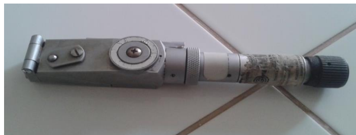
Figura 18: Refractómetro modelo N-1E, rango escalar de: 0,0 a 32°brix, escala mínima de 0,5.
