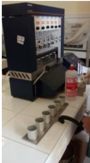
Figura A-4: Muestra preparada de Harina de Trigo, Harina de Kiwicha y Grano entero de Chía para colocar en el equipo extractor Soxhlet – marca Soxtec.
