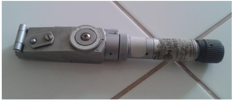
Figura 16: Refractómetro modelo N-1E, rango escalar de: 0,0 a 32°brix, escala mínima de 0,5.
