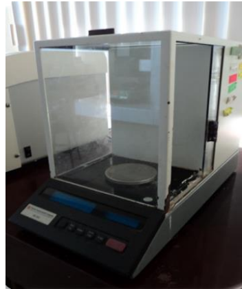
Figura 11: Balanza Analítica. Typ U3600, Sartorius
