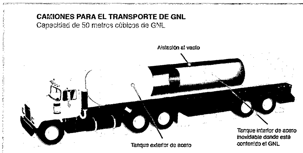
Figura N° 21 Transporte de GNL con cisterna aislada al vacío
