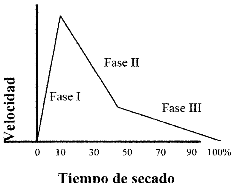
Figura N° 25: Etapas de la liofilización.
